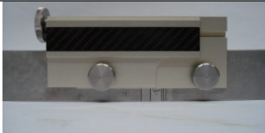
Spanner aufsetzen, Bolzen einsetzen, verspannen
